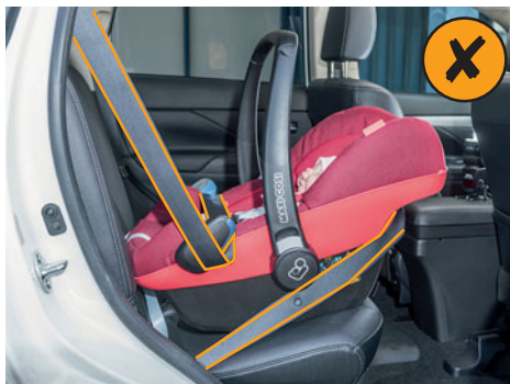
MAUVAIS cheminement de la ceinture : en cas de collision, la ceinture peut glisser et ne plus retenir la coque.
