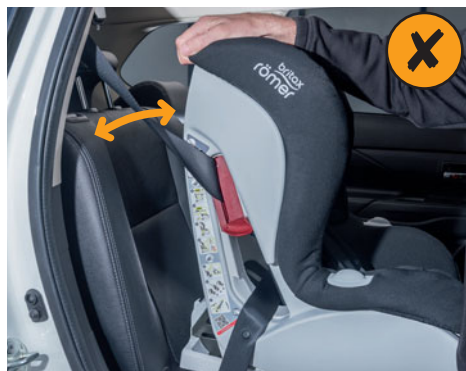
FAUX : installation trop lâche - le siège bouge et ne protège pas de façon optimale en cas d'accident.
