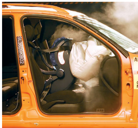
Danger mortel: la vitesse du déploiement de l'airbag est de 250 km/h et l'enfant est catapulté contre le dossier du siège.
