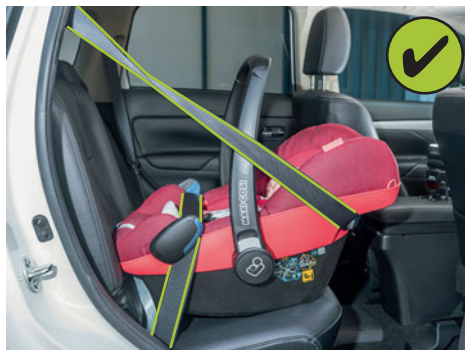
Cheminement CORRECT de la ceinture : en cas de collision, la coque sera retenue par la ceinture.
