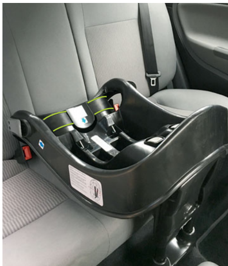
Embase pour coque pour bébé qui peut être installée avec la ceinture 2 points.
